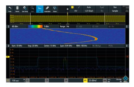
Tester le signal à partir de trois perspectives différentes : domaine temporel (en haut), spectrogramme (au centre) et domaine fréquentiel (en bas).
