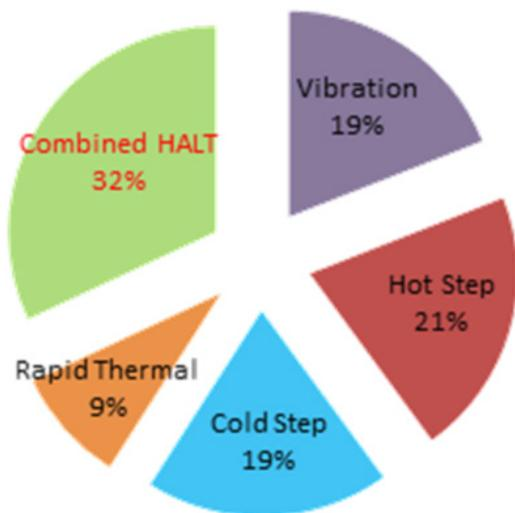
“ 32% de défauts non détectés sans l'utilisation de la **méthodologie HALT** par rapport aux moyens de test conventionnels. ”
