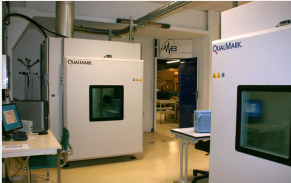
*Typhoon 3.0 - QUALMARK***Volume utile :** 1140 dm<sup>3</sup>**Température :** -100°C à +200°C**Gradient (VRT) :** 60°C/min**Vibration :** 50gRMS, 6 axes de liberté sur un large spectre (jusqu'à 10 kHz)
