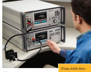
référence du mesureur de puissance de radiofréquences. L'option consiste en un « point étalonné » à l'extrémité d'un câble de précision de grade de métrologie de niveau/phase stable. Elle calcule la puissance mesurée avec une charge de 50 ohms.
