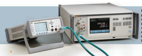
La gamme de la bande passante élargie du 5790B étend sa charge de travail pour l'étalonnage des sorties de référence de 50 MHz des mesureurs de puissance de radiofréquences tels que le Keysight N1914A.
