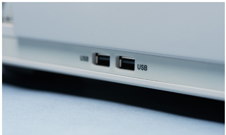
Des ports USB sont placés à l'avant et à l'arrière pour le téléchargement de constantes et la communication à distance avec le PC.
