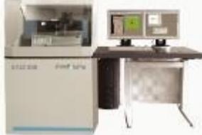
**Microscope acoustique haute performance destiné à l'investigation non destructive, au contrôle de qualité et de processus de fabrication.**
