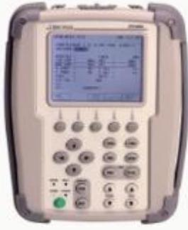
Testeur de piste dédié au test des installations de transpondeur, DME et TCAS.
